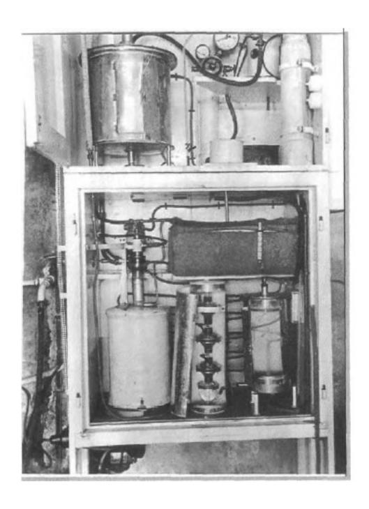
Apparatur zur Herstellung von quellwasserähnlichem Trinkwasser
